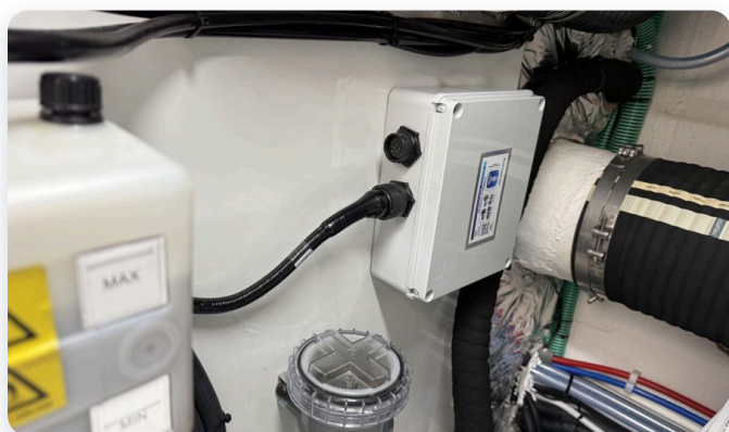
Contrôleur monté avec la prise HDP20 du Y-tap connectée et verrouillée.
