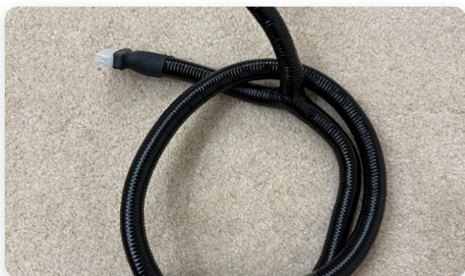
Le câble Y-tap : deux extrémités Mini-Fit Jr et une prise HDP20 pour le contrôleur.
